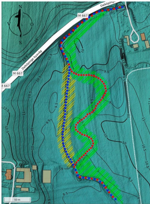
Figur 14. Bilden visar hur området kommer att se ut efter genomförandet av föreslagen åtgärd. Röda punkter ny åfåra. Blå punkter gamla åfåran. Källa Naturentreprenad Syd AB.
