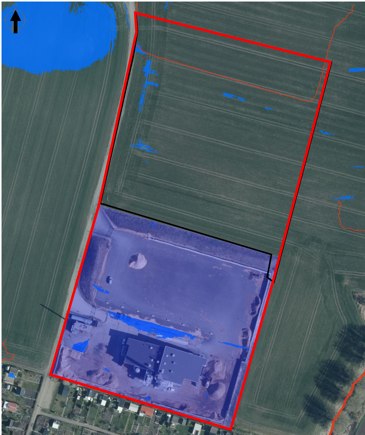
Figur 13. Skyfallskartering. Röd polygon visar utredningsområdets utbredning. Blå områden visar befintliga lågpunkter inom och utanför utredningsområdet. Bild försedd av Marklund Solutions AB den 7 oktober 2022.
