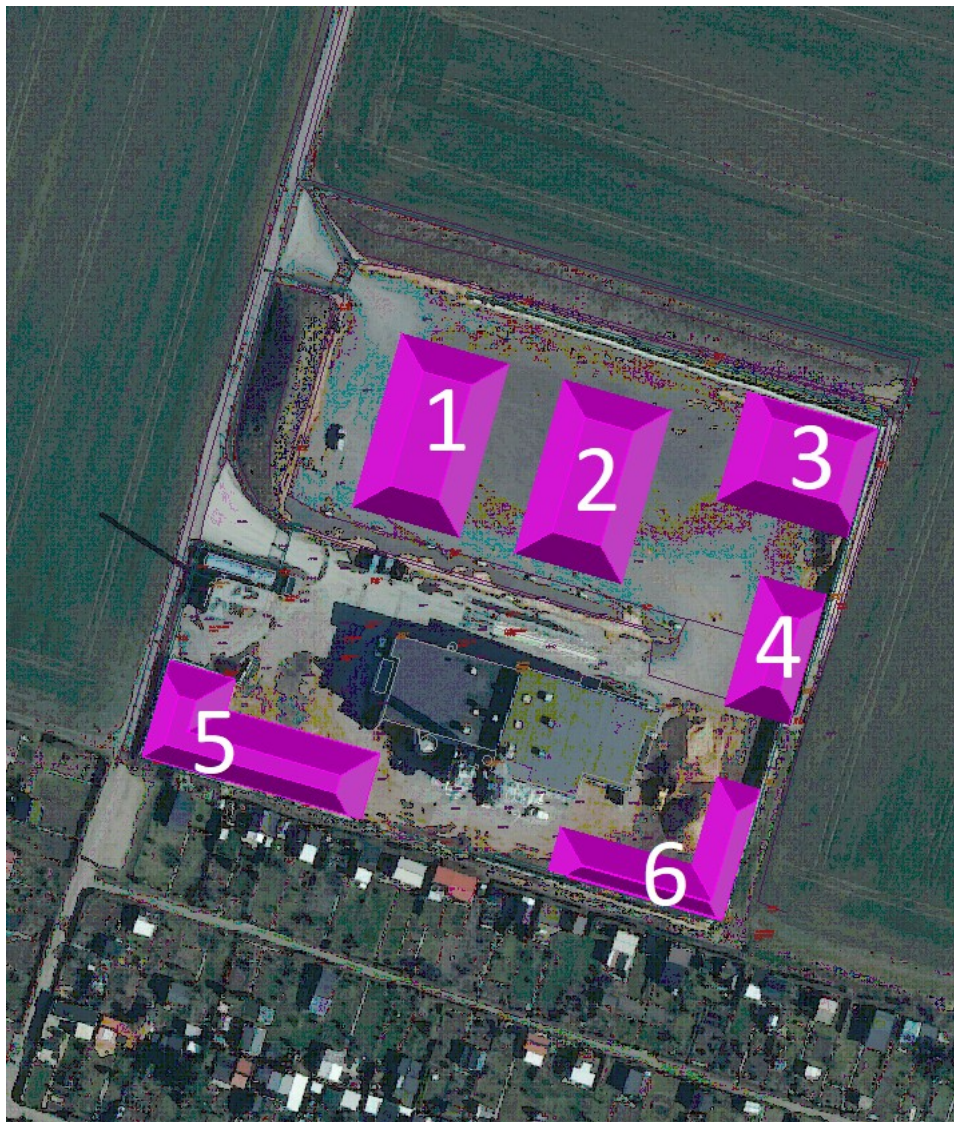
Figur 2.3. Skiss över beräknade upplagsytor för bränsle på befintlig anläggning visas i magenta. Figur: Ingenjörfirman Rörkraft, 2023.
