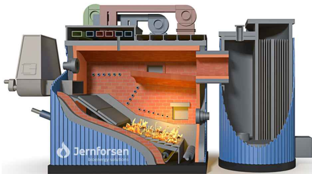
Figur 2.3 Fastbränslepanna av typen rosterpanna, likt ÖV1 och ÖV2 (källa: Jernforsen).
