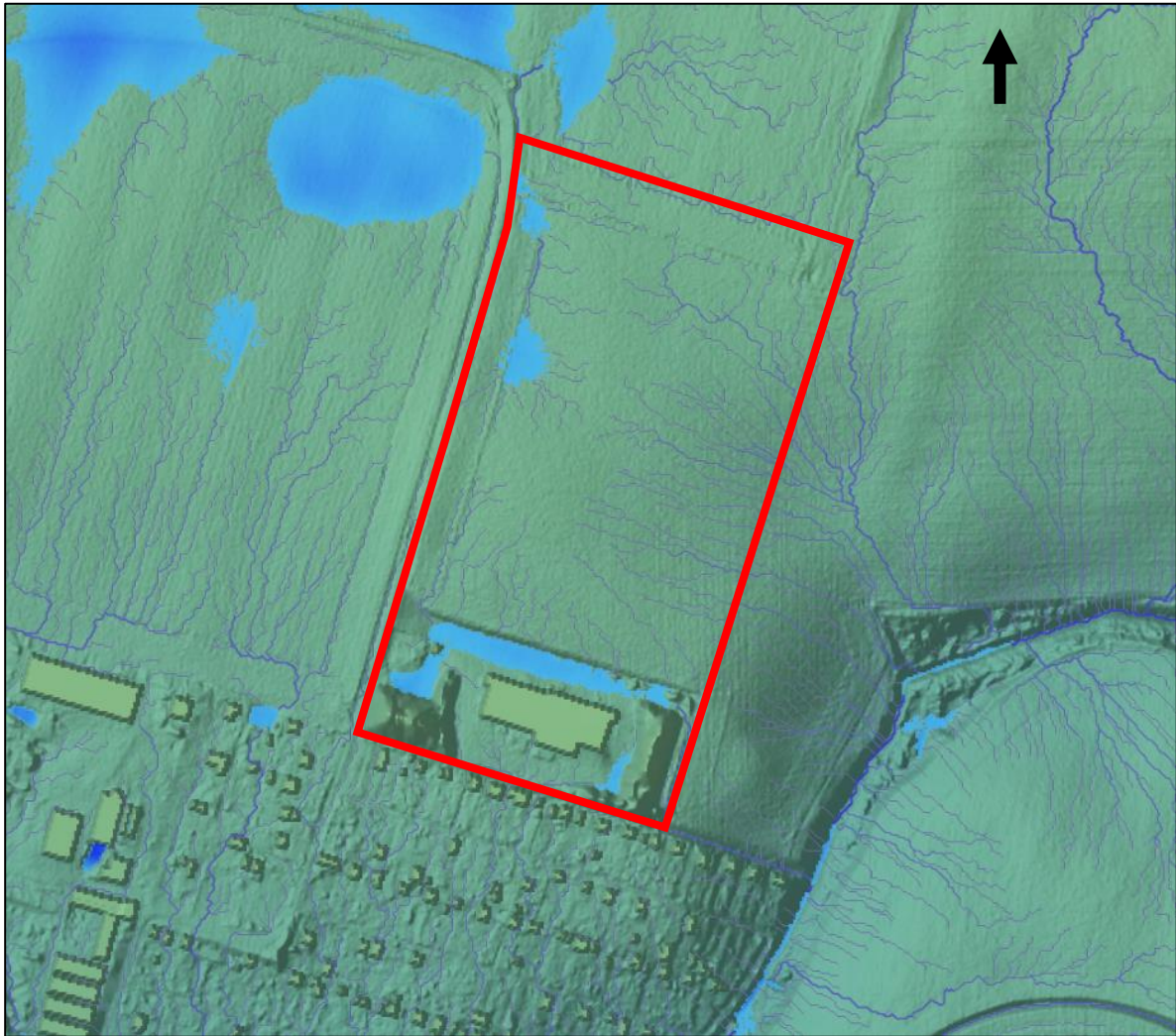
Figur 14. Områden som riskerar att översvämmas i samband med skyfall (nederbörds mängd 50 mm). Röd polygon visar utredningsområdets utbredning. Blå områden visar befintliga instängda områden inom och utanför utredningsområdet, blå linjer visar sekundära avrinningsvägar. Kartbild hämtad från SCALGO Live 2022-11-06.
