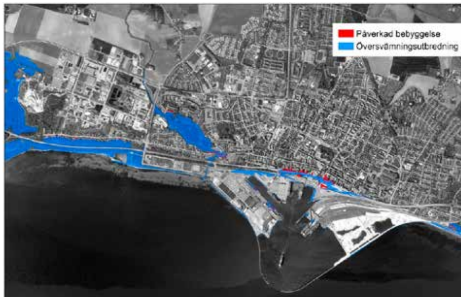
Översvämningsutbredning vid havsvattenstånd +1,85 m (relativt RH2000) visas i blått. Påverkade byggnader är markerade i rött.
