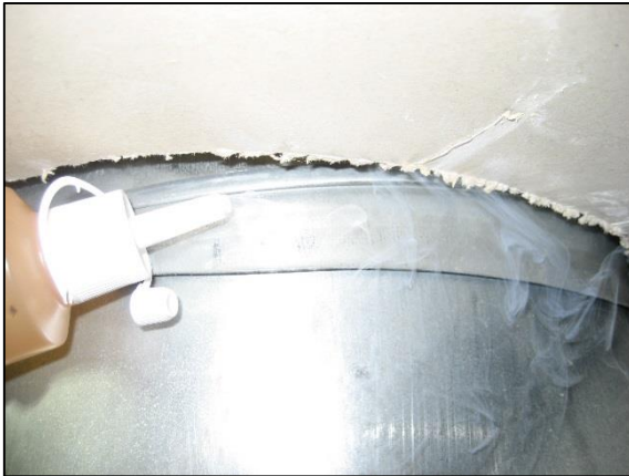
Foto 14, luftläckage ner konstateras vid vent.rör
