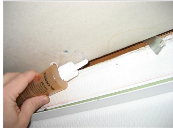
Foto 15, luftläckage ner konstateras, tak/väggvinkel
