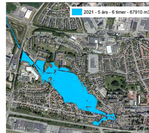
Området runt Flaningen riskerar, till följd av avrinning uppströms, att översvämmas när slussluckan är stängd utan pumpstation redan vid en 5-årshändelse i 6-timmar.
