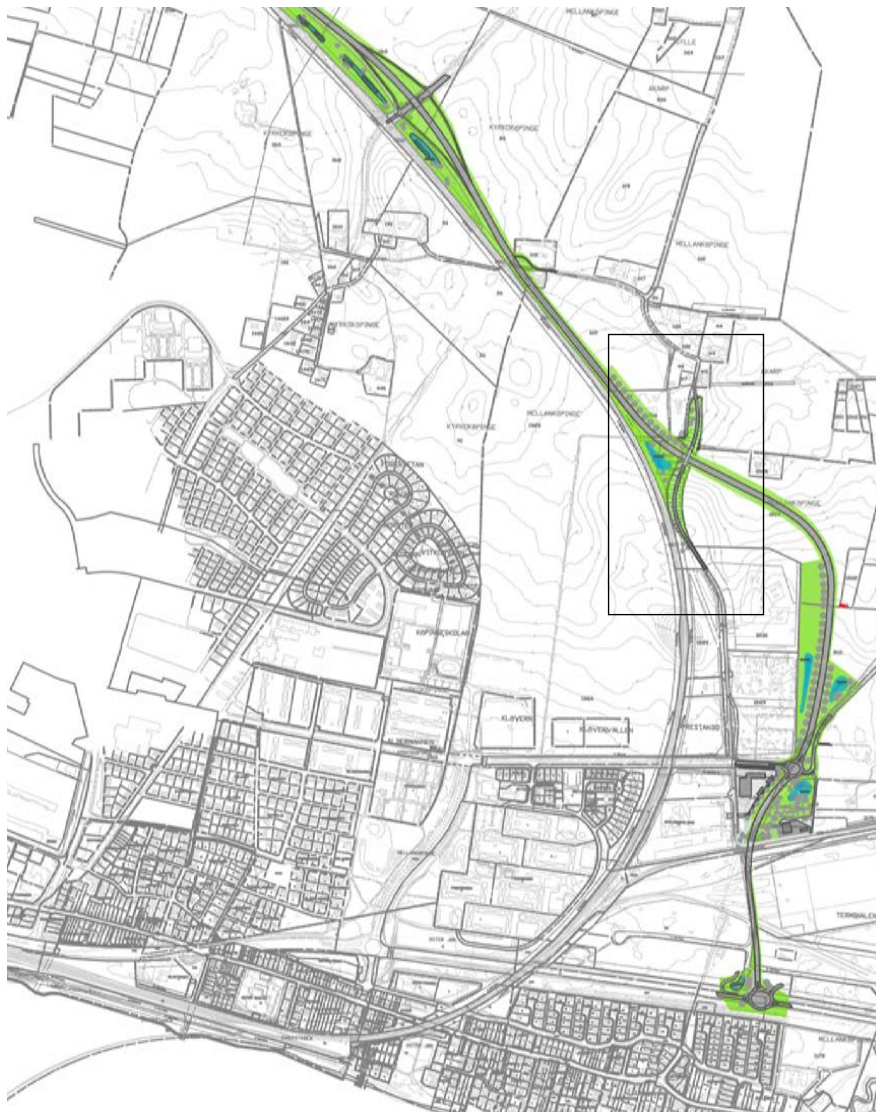
Illustrationsplan som visar Östra ringvägen och dess planerade anslutningar samt inzoomad detalj som visar Mellanköpingevägens föreslagna vägbro och sträckning. (föregående sida)
