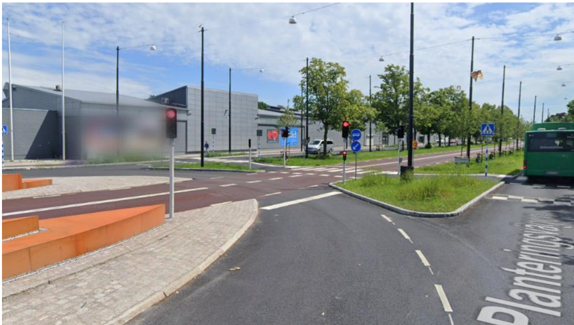
Figur 31. Exempel av en enkel signal på Planteringsvägen i Helsingborg som vanligtvis är släckt men där signalen slår om till rött när en buss på bussgatan vill passera korsningen(bild: Google maps).
