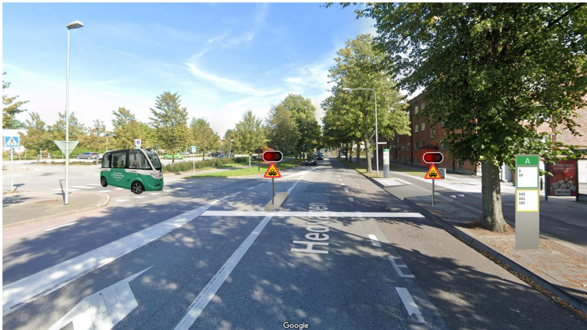
Figur 41. Exempel på utformning vid Hedvägen av busspassage med enkel trafiksignal (Ramboll).
