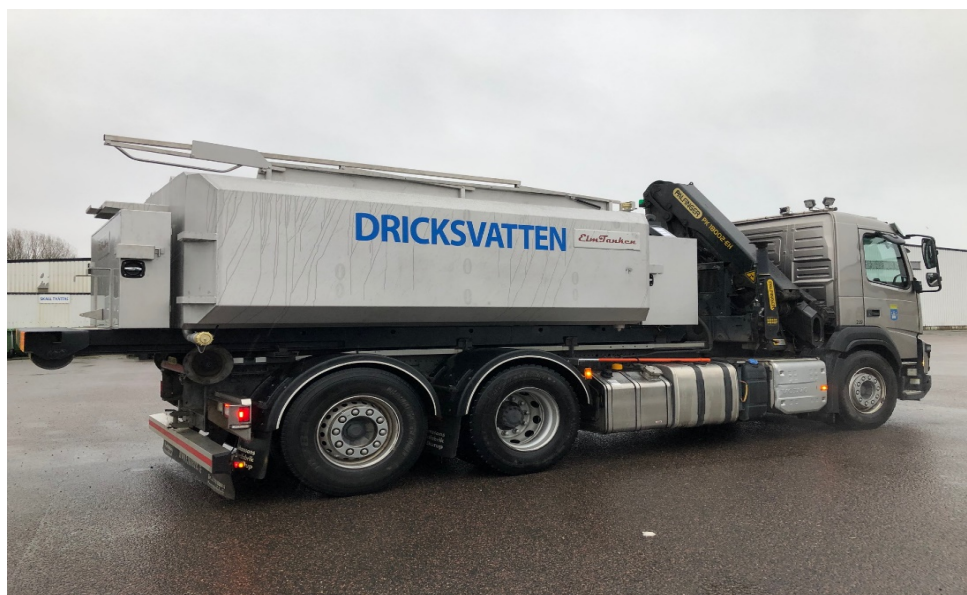
Nödvattentank på 10m 3 Foto: VA-Avdelningen Trelleborgs kommun
