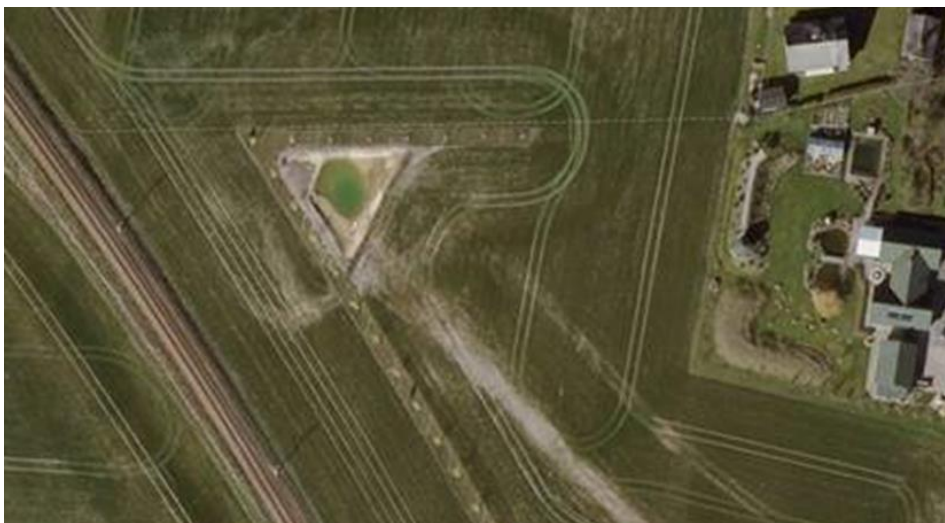
Figur 7.32. Nyplanterad pilevall samt nyanlagd damm vid Mellanköpinge (markerad nr 5 och 6 på översiktskarta). Vattenytan är mellan 90-100 m 2 stor.
