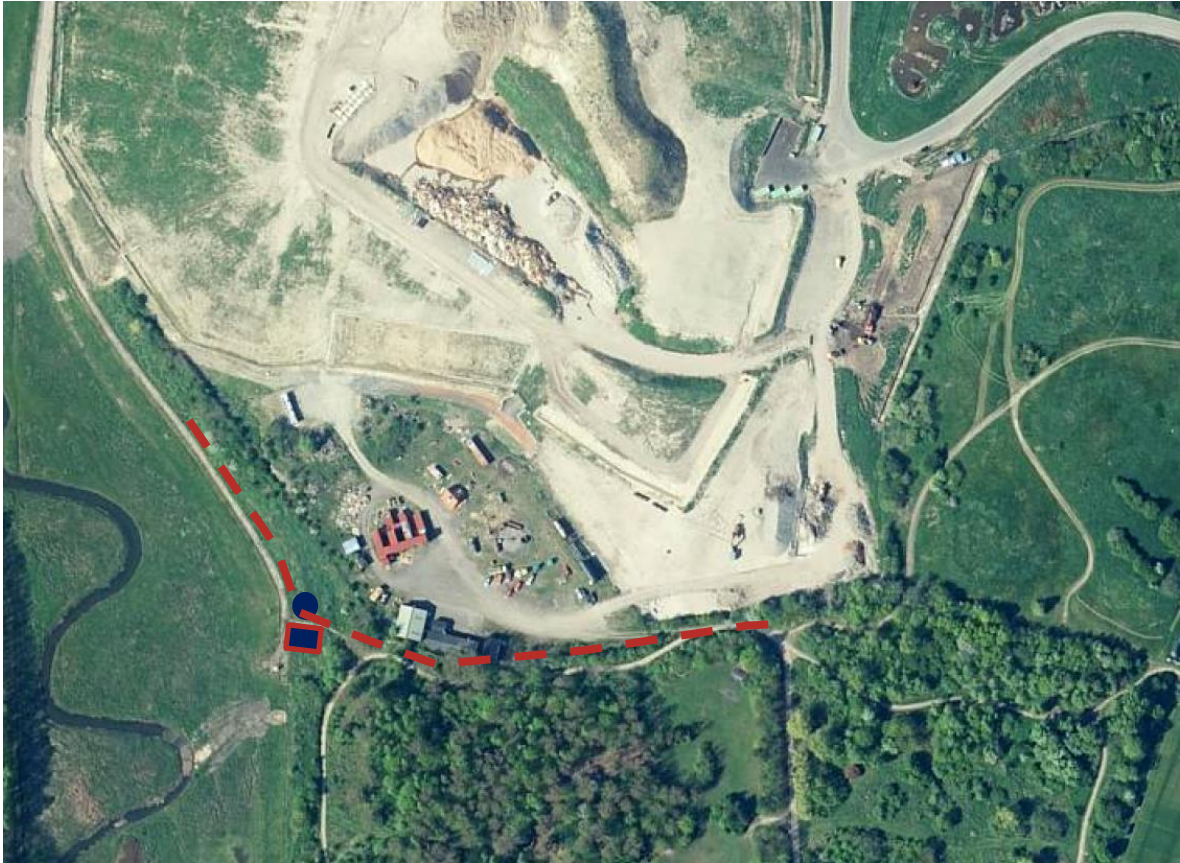
Figur 7. Redovisning av preliminär sträckning på dräneringsledning (röd streckad linje) samt läge för pumpbrunn (blå cirkel) och reningsanläggning (blå rektangel).
