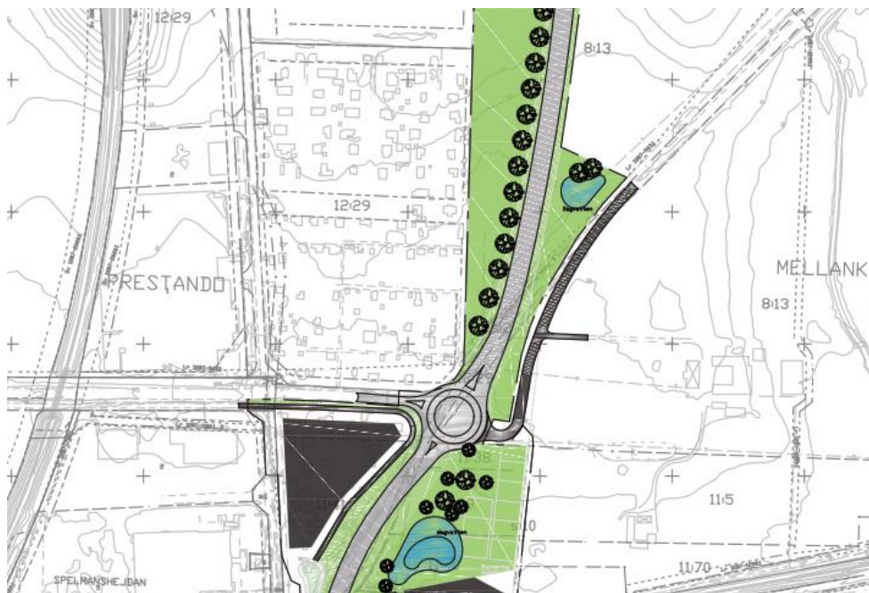
Figur 7.32. Illustration av Östra ringvägens korsning med Engelbrektsgatan/Dalköpinge byaväg, se E i Figur 4.1. Figuren visar förslag på plats för ny allé inom nya naturområden mellan Östra ringvägen och koloniområdet. En liknande lösning planeras för nya naturområden mellan Östra ringvägen och Rättspsykiatriskt centrum.
