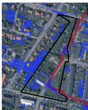
Figur 3 Flödesväg vid skyfall (röd färgmarkering) samt stående vatten (blå färgmarkering) i östlig riktning från vattendelare.
