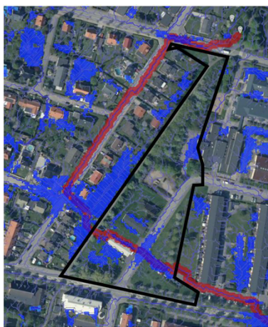
Figur 2 Flödesväg vid skyfall (röd färgmarkering) samt stående vatten (blå färgmarkering) i västlig riktning från vattendelare. Vattnet rinner väster om planområdet längs Ekevägen och sedan genom planområdet
