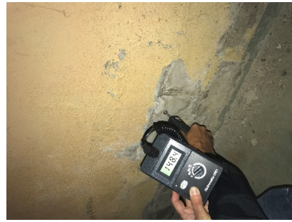
Fuktindikatorn visar att materialet i källarväggen är vått.
