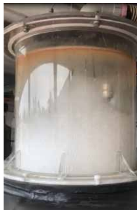
Figur 3: Foto taget vid utförande av det andra fraktioneringssteget i en fullskalig anläggning. Här ser man hur det torra skummet bildas och avlägsnas med vakuum.
